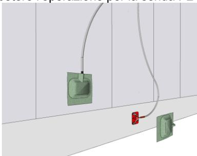
Posizionare la sonda di temperatura
