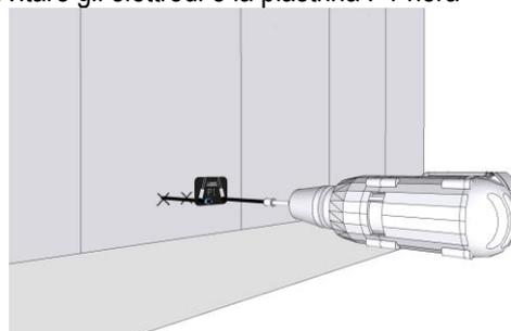
Fissare la sonda agli elettrodi
