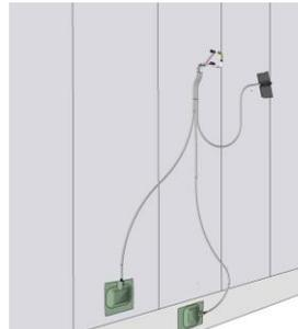
Posizionare il tubo corrugato per il passaggio del cavo bus
