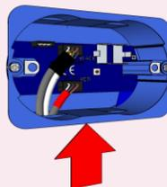
Inserire la batteria nel sensore
