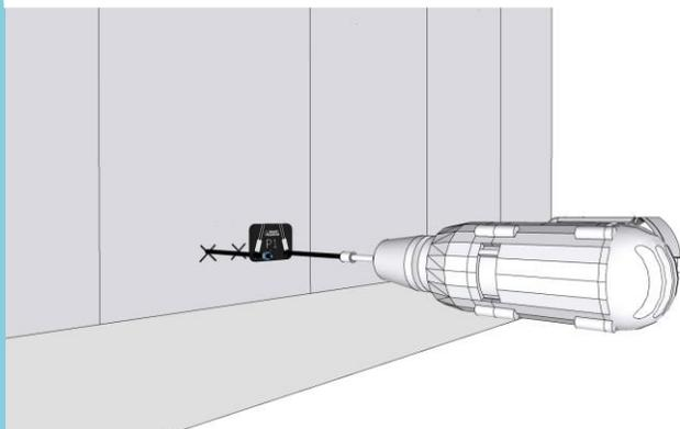
Fissare la sonda agli elettrodi
