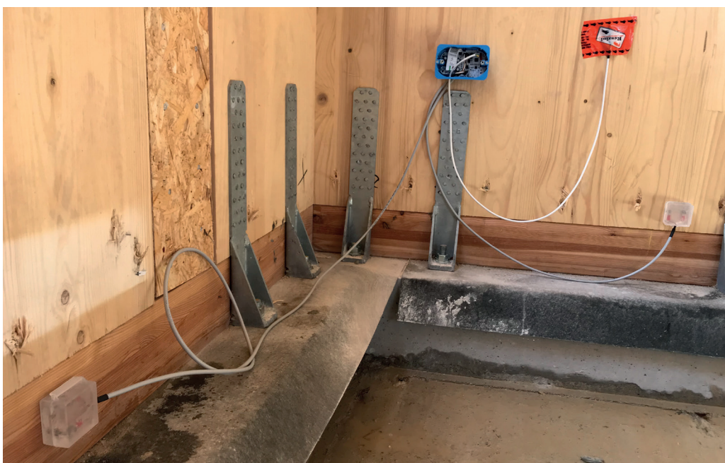
Sensore collegato a sonde di umidità e di temperatura
